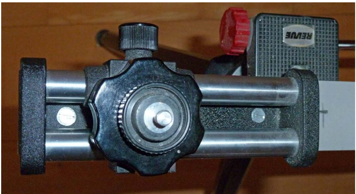
Der auf dem Profil befestigte Einstellschlitten
