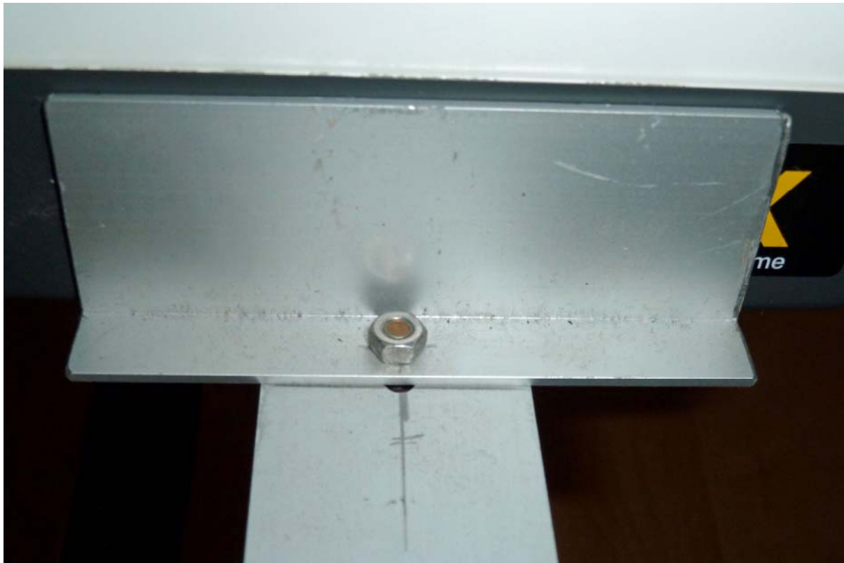
Die Halter für die Leuchtplatte (Vorder- und Rückseite gleich. Ggf. kann das Profil auf der Vorderseite auch anders herum verwendet werden; dann die Leuchtplatte auf der Rückseite zusätzlich mit Klebeband sichern.
